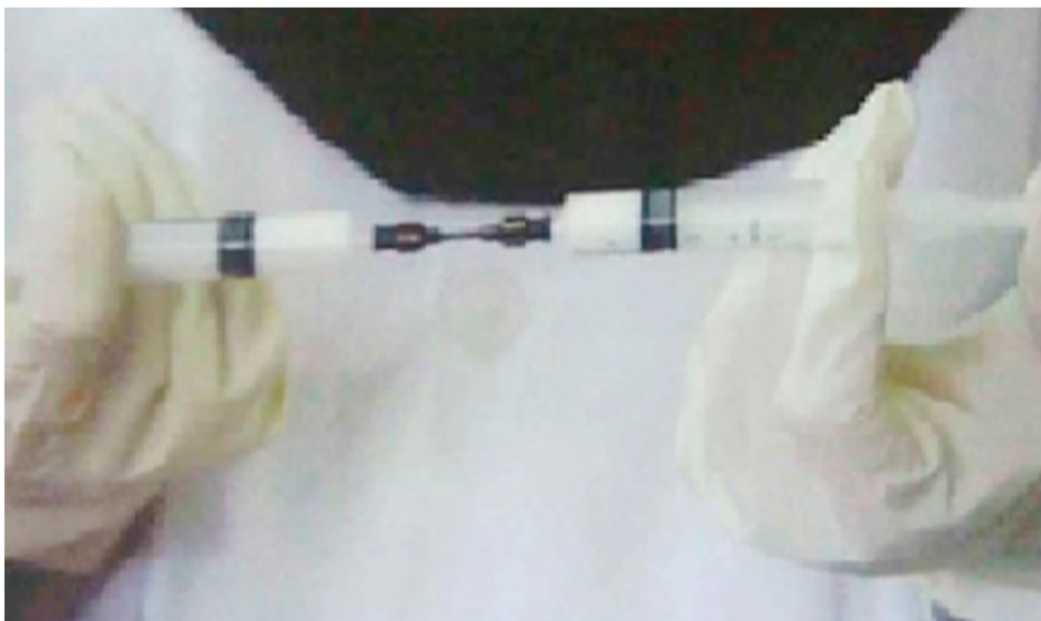
شکل ۱- نحوه هموزنیزه کردن آنتی ژن K۹۹ ای-کولای غیر فعال شده با ژل آلوم به وسیله پل ارتباطی.
