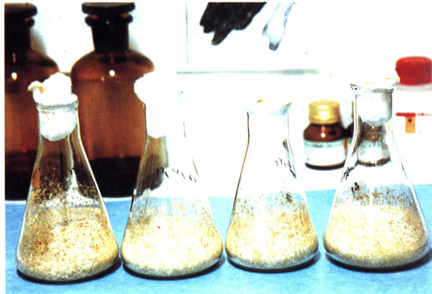
شکل شماره ۷ - فلاسکهای گروه آزمایشی و میسلیومهای رشد داده شده بر روی بستر کاه گندم
