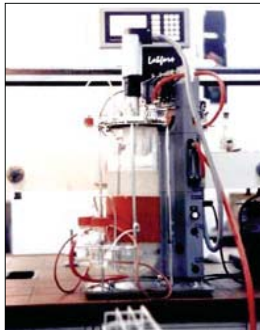
شکل ۱- فرماتور آزمایشگاهی Infors با حجم VL
