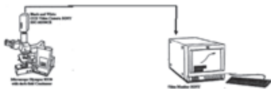
شکل ۱- میکروسکوپ فازکنتراست مجهز به دوربین، متصل به رایانه
