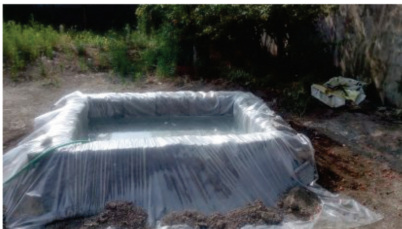
شکل ۱- استخر مورد استفاده در آزمایش. طول استخر ۲/۵ متر، عرض ۱/۵ متر و با ارتفاع ۵۷ سانتی متر
